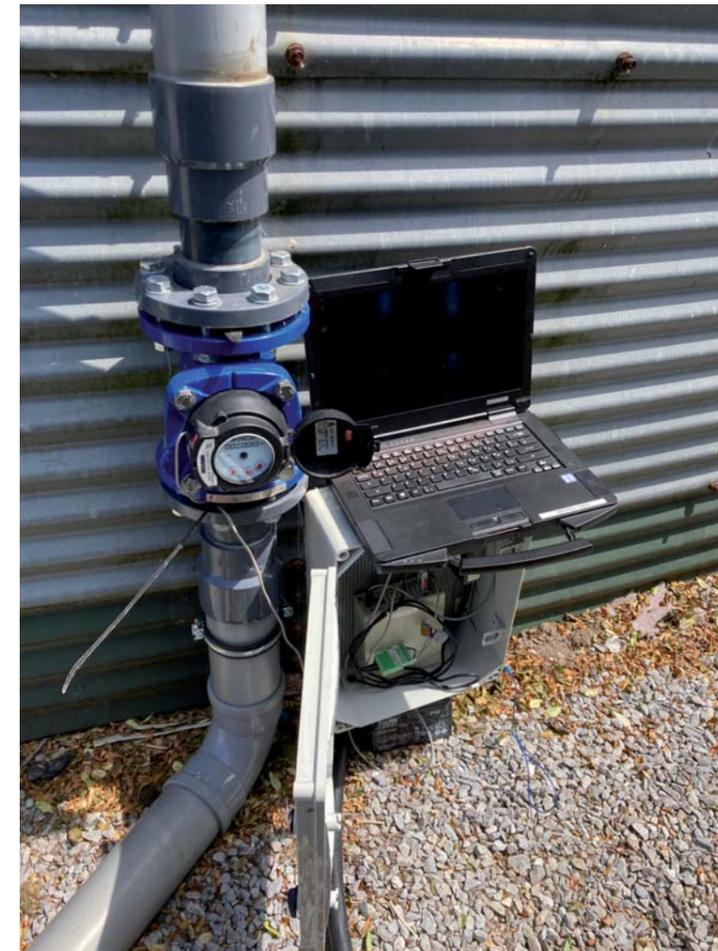
Abb. 11: Volumetrische Messung und Auswertung des zurückgeführten Drainwassers
