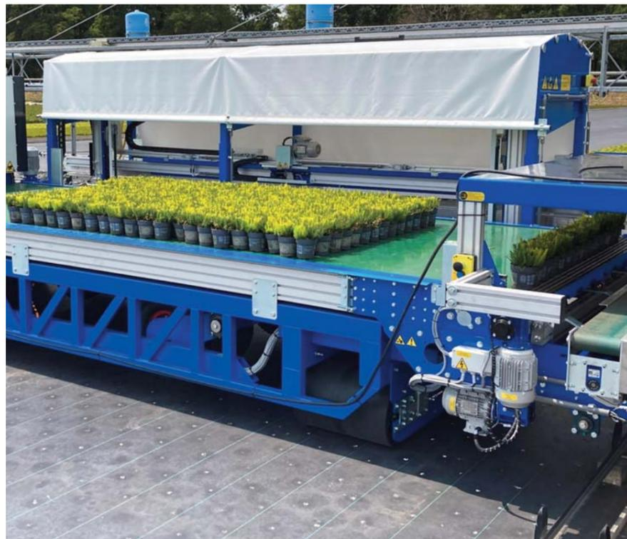
Abb. 8: Exaktgießwagen mit Absetzroboter
