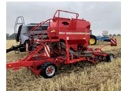
Abb. 7: Direktsaat Zinkendrillmaschine Horsch Sprinter
