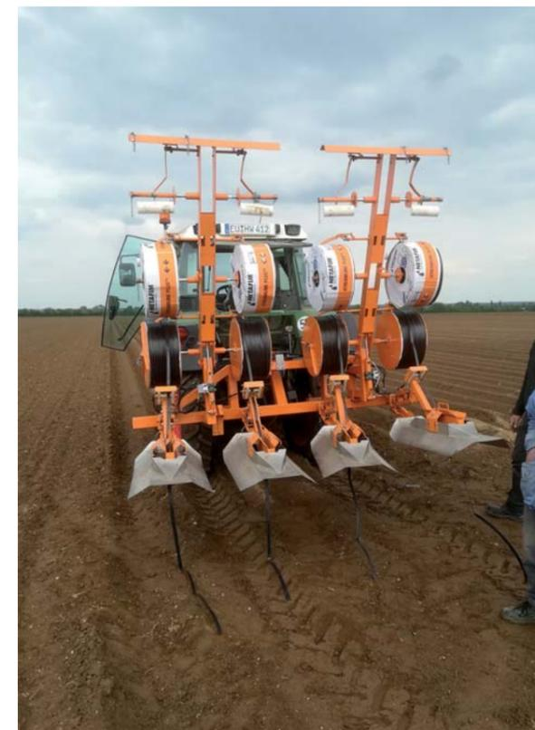
Abb. 1: nachträgliches Einziehen der Tropfschläuche in den Damm
