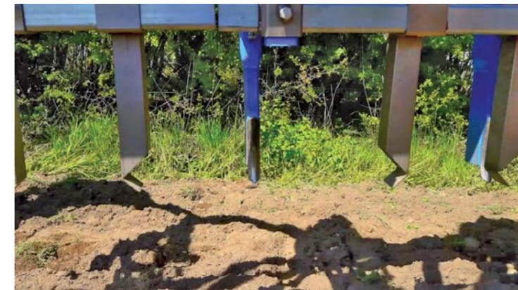
Abb. 1 Aufbau: links und rechts Prallbleche, mittig Düngechar
