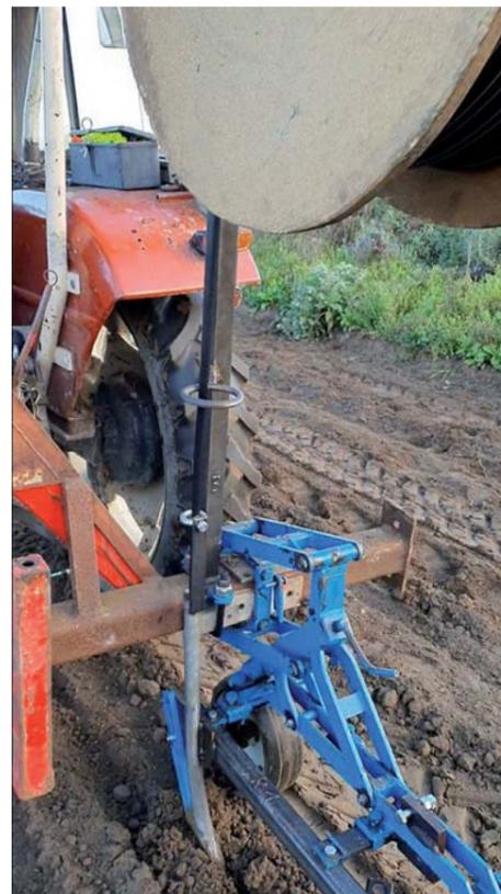
Abb. 2: Verlegeeinheit mit Tropfschlauchtrommel am oberen Bildrand
